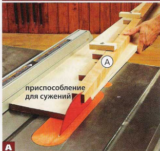
A Выпилите сужения на двух смежных гранях каждой ножки А с помощью простого приспособления. Внешние грани ножек остаются прямыми.
