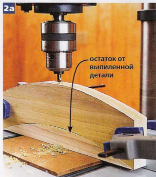
Обрезок, оставшийся при выпиливании контура, лежащий на тонкой подкладке, послужит подпорным бруском для сверления сквозного отверстия в криволинейной детали.
