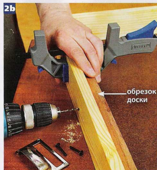
Для предотвращения сколов на задней стороне подпорный брусок из обрезка доски прижат струбциной изнутри ящика. Если при сверлении образуется больше мелкой пыли, чем стружки, сверло нуждается в заточке.
