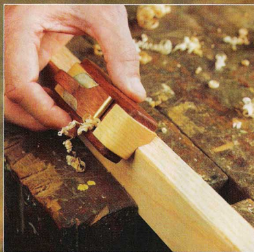
Чтобы снять фаску на ребре, просто проведите рубанок наклонной частью подошвы вдоль кромки заготовки.
